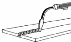
Рисунок 21. Сварка в нижнем положении
