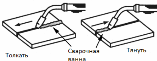
Рисунок 19. Направление движения горелки
