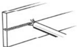
Рисунок 13. Горизонтальное положение при сварке
